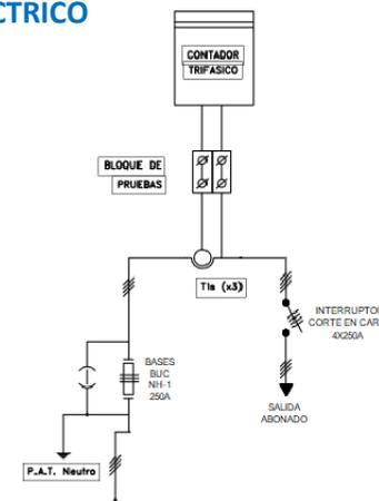
CPMS DE MEDIDA INDIRECTA (100 KW <math>P \le 150 \text{ KW}</math>) ENTRADA Y SALIDA POR LA PARTE INFERIOR
